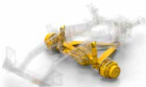
Für besseren Arbeitskomfort reduziert die A-Rahmen-Aufhängung mit hydro-pneumatischen Dämpfern die häufig im Off-Road-Betrieb auftretenden seitlichen Schwingungen. Eine wirkungsvolle Federung des Fahrersitz schützt den Fahrer zusätzlich.
