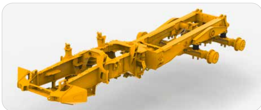
Le châssis en acier haute résistance offre solidité et rigidité sans poids excessif.
