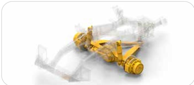
Para una productividad con mayor comodidad, el sistema de suspensión con estructura en forma de A y puntales de suspensión hidroneumáticos, reduce la vibración lateral que se suele experimentar cuando se conduce fuera de la carretera. El asiento con suspensión mejorada proporciona un aislamiento adicional para el conductor.
