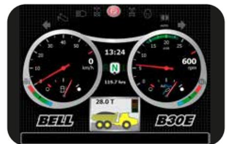
El exclusivo pesaje a bordo ofrece al conductor información en tiempo real sobre la carga mientras se está cargando la máquina. También se puede activar un modo de "limitación de velocidad" si la máquina está significativamente sobrecargada.
