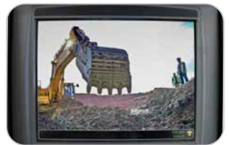
Una cámara trasera integrada opcional y retrovisores de alta visibilidad garantizan una visibilidad superior en todas direcciones.
