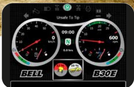
La incorporación de un sensor de inclinación longitudinal y lateral en el vehículo evita el accionamiento del volquete si el dumper se encuentra en una posición insegura.
