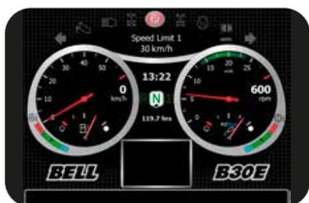
El control de velocidad máxima seleccionable, para el conductor o el sitio de trabajo, permite desacelerar automáticamente el vehículo y accionar el retardador para evitar el exceso de velocidad en el lugar de trabajo.
