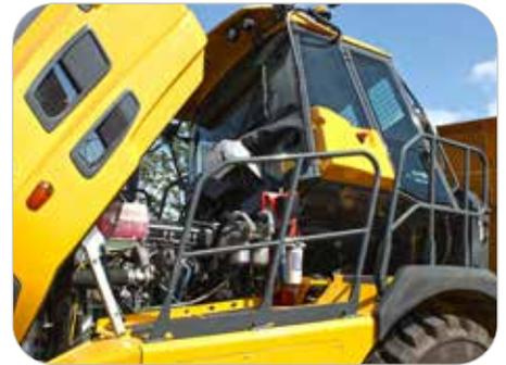
La cabina se puede inclinar en pocos minutos sin necesidad de herramientas especiales para un práctico acceso a los componentes de la transmisión.
