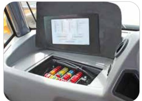
El centro de carga en el interior de la cabina simplifica el cambio de fusibles. Menos relés, conectores y arneses de cables significan mayor fiabilidad.
