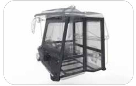
Nuestras silenciosas cabinas están certificadas contra el vuelco y la caída de objetos (ROPS/FOPS) y equipadas con un asiento del conductor con suspensión de aire. El asiento del instructor lleva un cinturón de seguridad sub-abdominal retráctil, mientras que el asiento del conductor lleva un cinturón de seguridad estándar con 3 puntos de sujeción. Ambos poseen retractores de bloqueo automático.
