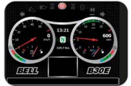
Un monitor a color de 10" fácil de usar ofrece información esencial sobre el funcionamiento, advertencias de seguridad, datos de diagnóstico detallados y ajustes de las funciones del volquete.
