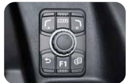
El mando de tipo automóvil permite navegar por el menú en el monitor a color para extraer información acerca del funcionamiento y los ajustes de la máquina.
