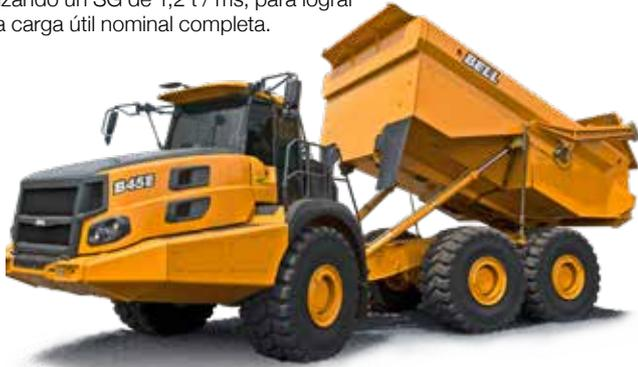
Como el carbón es más liviano y menos abrasivo que la sobrecarga típica, la placa de acero utilizada en las cajas de carga de carbón no es tan gruesa como las cajas de carga de los volquetes articulados (ADT) estándar. Como resultado, no se puede utilizar para transportar más materiales agresivos. Para las artesas de carbón se suministran puertas traseras.
